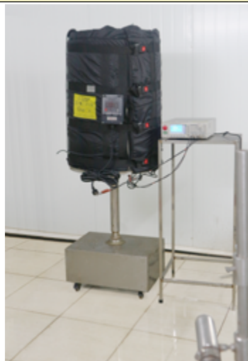
Messung des Isolationswiderstands nach IPx6-Tests
