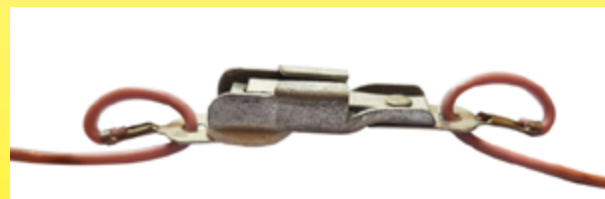
Temperaturbegrenzer für Calor-Heizmatten mit langsamer Unterbrechung, geeicht auf 80°C (ca. 1960). Man beachte die wasserdichte PVC-Hülle, die auf die Drähte geschweißt ist, und die Schleife, die durch die elektrischen Leiter gebildet wird, die durch ein Loch in jeder Klemme geführt werden - dies dient dazu, Zugspannungen auf den Draht zu vermeiden (Ultimheat-Sammlung).
