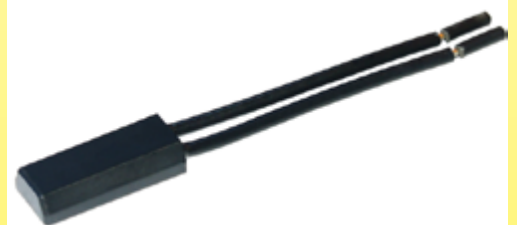
2019 Abknickbarer Temperaturbegrenzer für Heiztransformatoren, abgeleitet vom Modell 7AM von Texas Instruments aus dem Jahr 1966, verwendbar bei 230V, in wasserdichtem Kunststoffgehäuse. Temperaturbereich von 5 bis 8°C. Typ V7AM (Ultimheat-Sammlung).
