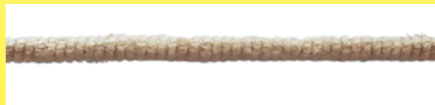
Ca. 1960. Calor-Heizschnur, Durchmesser 1,7mm, einfacher Nickel-Chrom-Heizdraht, Durchmesser 0,08mm, auf einer leicht gedrehten Baumwollseele, um ein Knicken zu verhindern (Ultimheat-Sammlung)
