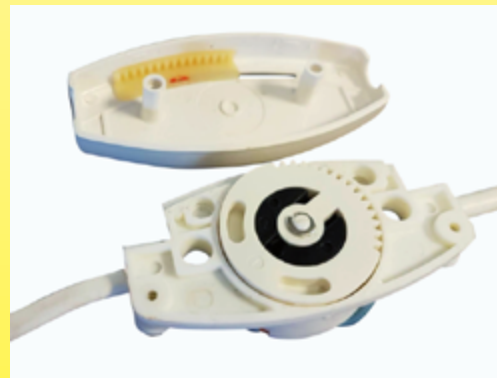
3-Stellungs-Heizungsschalter und 2-Stellungs-Stoppeschalter auf der Heizdecke. Zwischenmodell zwischen Rotationssystemen und Schiebeseystemen (ca. 1970, Gitem, Ultimheat-Sammlung)
