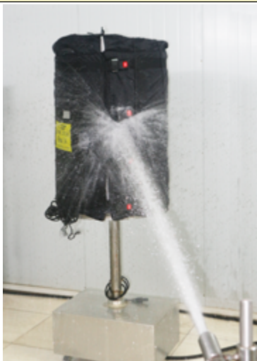
IPx6-Prüfung von Heizmänteln
