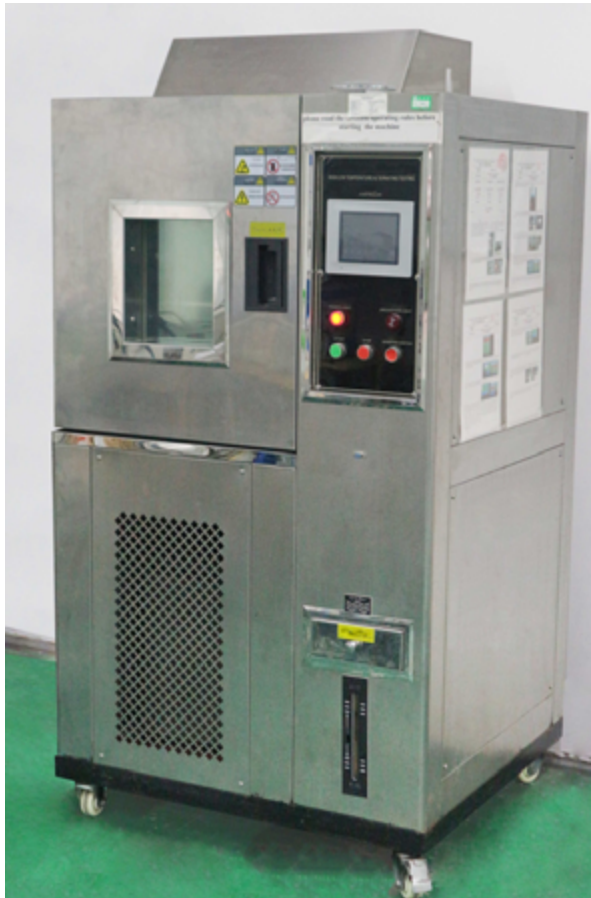
Klimakammer, mit Temperatureinstellbereich von -90 bis +150^{\circ}C , Einstellbereich der relativen Luftfeuchtigkeit 1 bis 100%
