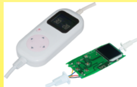
2019 Regelgerät für temperaturgeregelte Heizdecken mit Digitalanzeige über einen in der Heizfläche eingebauten Thermistorfühler (Ultimheat-Sammlung)
