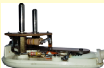
Ca. 1972. Schaltkasten der Firma Jidé in Limoges unter der Marke Jidéstat. Das erfolgreichste aller Systeme. Es ist sehr klein, einstellbar und in den Stecker integriert. Dies ist das einzige Modell mit einem Schnappmagnetkontakt. Es wurde erst in der heutigen Zeit von elektromechanischen Systemen überholt. (Ultimheat-Sammlung)
