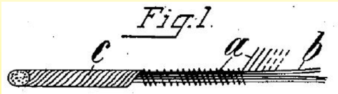
Heizschnur (patentiert von Camille Herrgott, 1901). A = Heizdraht; B = Textilkern; C = äußere Umwicklung entgegen der Richtung des Heizdrahtes
