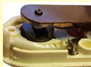
Ca. 1972. Schaltkasten der Firma Jidé in Limoges unter der Marke Jidéstat. Das erfolgreichste aller Systeme. Es ist sehr klein, einstellbar und in den Stecker integriert. Dies ist das einzige Modell mit einem Schnappmagnetkontakt. Es wurde erst in der heutigen Zeit von elektromechanischen Systemen überholt. (Ultimheat-Sammlung)
