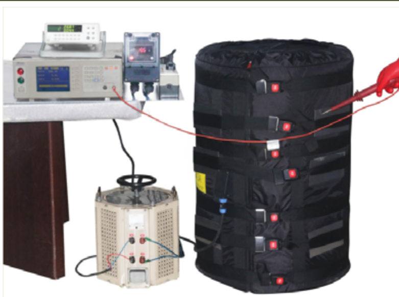
Messgeräte für den Gesamtableitstrom im heißen Zustand
