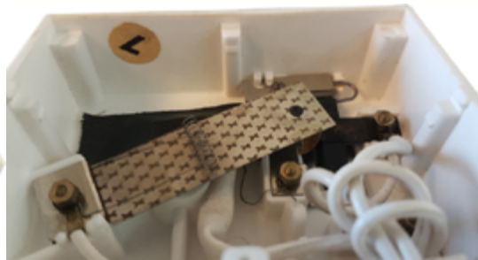
Ca. 1970. Leistungseinstellung von GEC (General Electric, England) an einer englischen Heizdecke. Der zu erwartende Widerstand ist deutlich über dem Bimetall und dem langsamen Unterbrecher zu erkennen. (Ultimheat-Sammlung).
