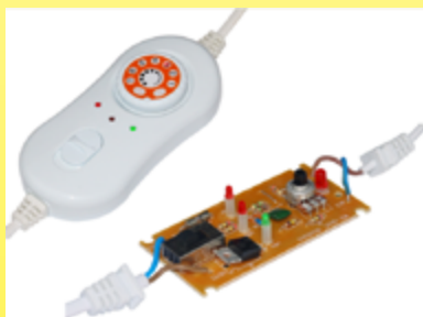
2019 Kontinuierliche elektronische Leistungsregelung Gummitch-Regelgerät (Ultimheat-Sammlung)
