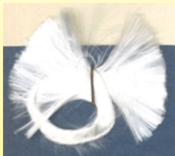
Bündel von Glasfilamentsträngen, die einen einzigen Draht bilden (Herstellung von Glasfilamenten, um 1960, Unterricht in der Textilschule von Verviers in Belgien, Ultimheat Museum)
